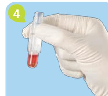
4 Kyvetu uzavrite viečkom s čídlom, pretrepávajte (nie dnom nahor) až do vyčírenia roztoku. Potom vložte kyvetu do meracieho otvoru a odmerajte blank (asi 20 sekúnd).
