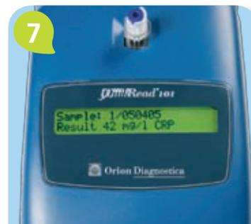
7 Ihneď po pípnutí vložte kyvetu nazad do meracieho otvoru. Za 1 minútu sa na displeji objaví výsledok.
